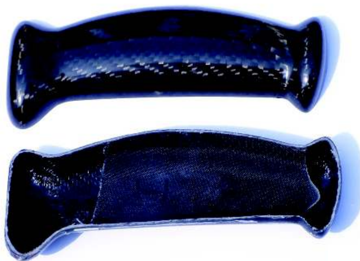
Zwei fertige Halbschalen des Knüppelgriffes direkt nach dem Entformen. Nach der Vorbereitung der elektrischen Einbauten werden diese zum kompletten Griff verklebt.
