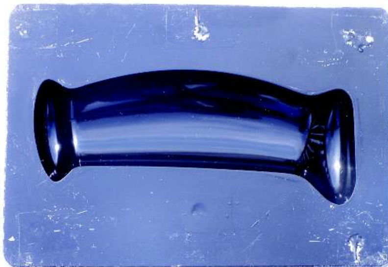
Eine der beiden Formhälften für den Bau des Knüppelgriffes
